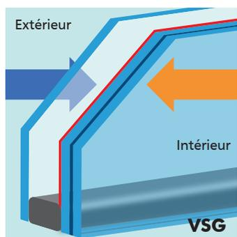
La vitre transparente intérieure avec revêtement thermo-isolant est exécutée en tant que verre de sécurité feuilleté. Pour cela, deux vitres transparentes de 3mm d'épaisseur avec un film très élastique en polyvinylbutyral (PVB) sont collées l'une à l'autre.
