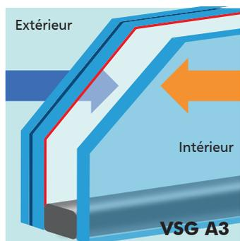
Avec cette version, la vitre avec revêtement thermo-isolant est composée de deux vitres transparentes collées l'une à l'autre avec quatre films très élastiques en polyvinylbutyral (PVB) pour la protection contre le vandalisme.
