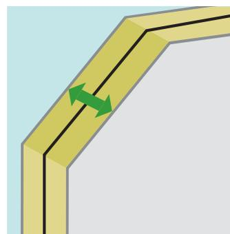
Une insertion métallique d'environ 1mm, qui est insérée dans la jonction en mousse, garantit un renforcement supplémentaire de l'ensemble de la structure du panneau.
